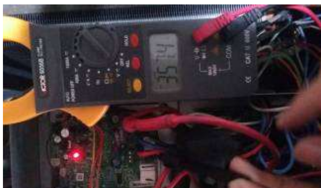
Bild E: Mät spänningen emellan DC- och DC+. Värdet borde vara DC 357V
